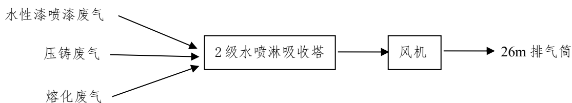
图 4.4.1-2 喷漆、压铸、熔化废气处理工艺流程
